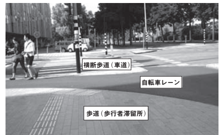
写真⑤ 自転車レーンと歩行者帯が明確に分離されているアムステルダムの交差点
